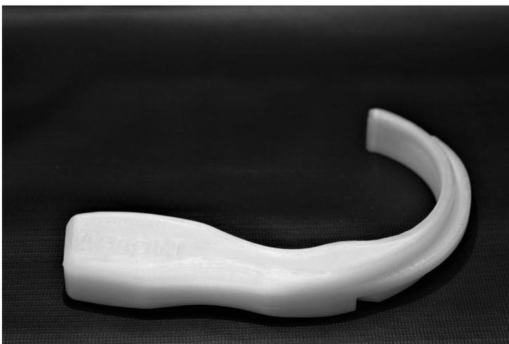
Figura 4: Laringoscópio impresso por tecnologia FFF utilizando como termoplástico o PLA. O custo para a sua fabricação oscila em torno de 20 a 30 reais e necessita do acoplamento de câmera boroscópica.
