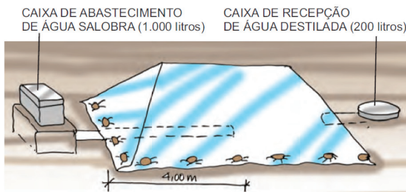
Figura 2- Destilador solar de baixo custo
